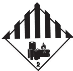
Знак «Класс 9. Прочие опасные грузы» и маркировка с номером ООН
